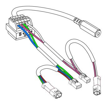
Der Powerschalter Kabelsatz für Yamaha ist genauso Steckbar wie der Standard Kabelsatz mit dem Unterschied, das der Dongle sich über den Lichtschalter am Display aktivieren und wieder deaktivieren kann.
