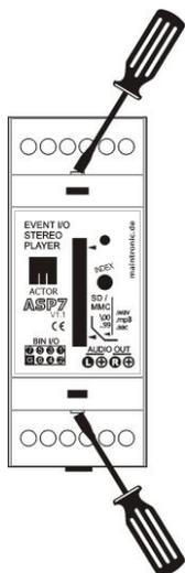
Um an die Anschlüsse zu gelangen wird die obere und untere Abdeckung entfernt. Mit einem Schraubendreher (wie in der Abb. Seite 7 dargestellt) in die dafür vorgesehenen Einkerbungen eindrücken und die Abdeckung nach oben abziehen.
