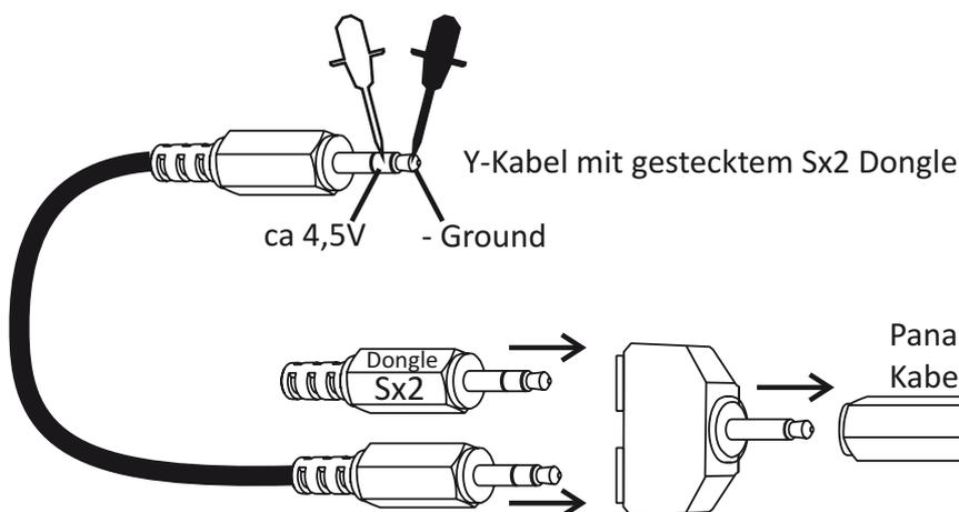
Wenn mit einem Y-Adapter der Dongle eingesteckt wird kann zusätzlich geprüft werden ob der Dongle funktioniert. Bei eingestecktem Dongle wird die Spannung sich reduzieren auf ca. 4,5V.
