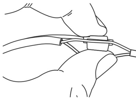
Danach mit einer Zange möglichst Parallel verpressen.
