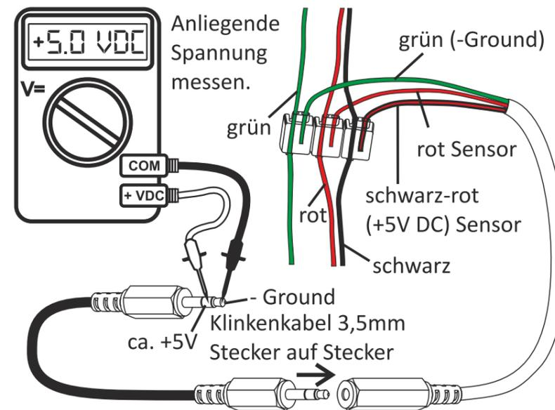
Wenn mit einem Y-Adapter der Dongle eingesteckt wird kann zusätzlich geprüft werden ob der Dongle funktioniert. Bei eingestecktem Dongle reduziert sich die Spannung auf ca. 4,5V.
