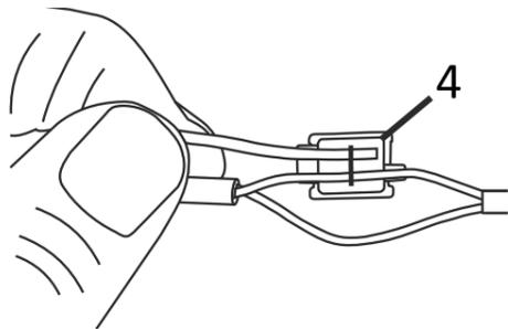
Einstecken der 2 Adern des Kabelkits (ohne Abisolierung) in die je einseitigen Öffnungen der Schneidklemmen (4).
